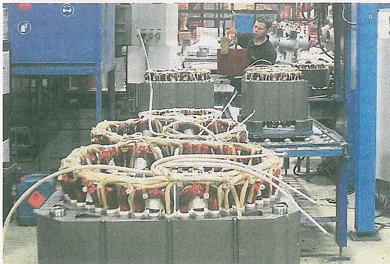
Lancor fabrica distintos modelos de motores eléctricos en sus instalaciones de Gallarta.
